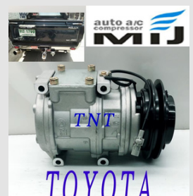
TOYOTA MIJ-T777 Land Cruiser.4.0/4.5 6.cyl./13.0TD Hiace.DSL.1992~97- 10PA17C.12V.1A./130mm โตโยต้า แลนด์ ครุยเซอร์
